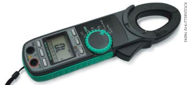
Vale salientar que o alicate-amperímetro mede apenas corrente alternada, e o núcleo que compõe as garras é laminado, para que as perdas por correntes de parasitas sejam minimizadas.
