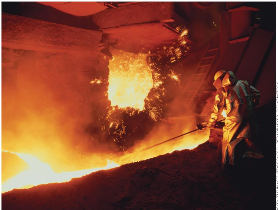
O **cadinho** é onde o ferro-gusa é depositado. Como a escória (impurezas que se formam durante o processo) deve ser separada do ferro, nesta etapa ocorre esta separação. A escória é menos densa que o ferro e flutua no cadinho, no qual existem dois furos: o furo superior para escoamento da escória e o furo inferior, que é aberto quando se deseja que o ferro líquido escoe.
