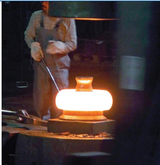
Esse aquecimento é feito em fornos de tamanhos e formatos variados, relacionados ao tipo de metal usado e de peças a serem produzidas e vão desde os fornos de câmara simples até os fornos com controle específico de atmosfera e temperatura. Alguns metais não ferrosos podem ser forjados a frio.
